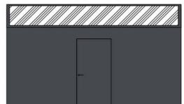
5000 мм. – металлический каркас + сэндвич панель, без учёта накладных элементов
